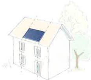
Selon les cas, regrouper les capteurs en un seul élément de forme rectangulaire, axé sur les ouvertures de façade, et positionné en pied de toit.
