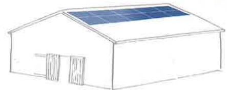
Privilégier une implantation horizontale des capteurs, sur toute la largeur de la toiture. Les capteurs sont positionnés au niveau du faîtage.
