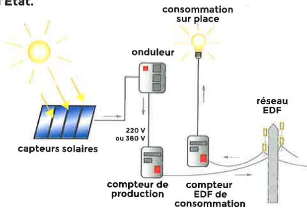
Installation photovoltaïque connectée au réseau
