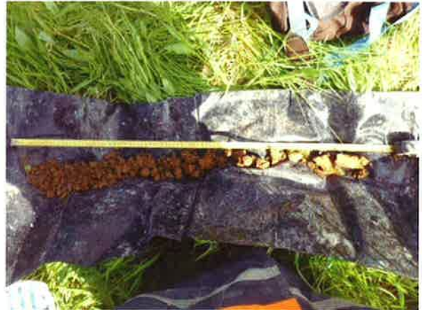
◆ S002 : ensemble du sondage
